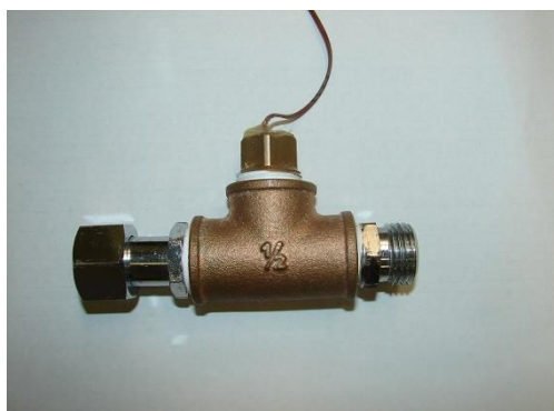
図 8.12.1 熱電対を取り付けた継手配管
