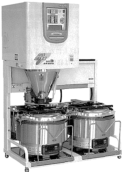
全自動2釜タイプ (ガス式)
