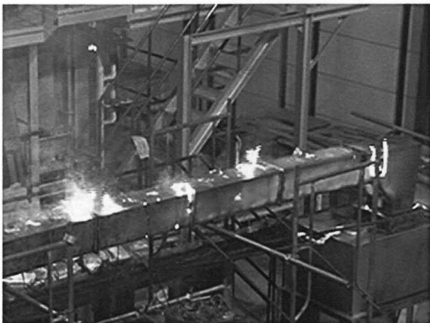
写真 ダクト内まで延焼した実験の様子
