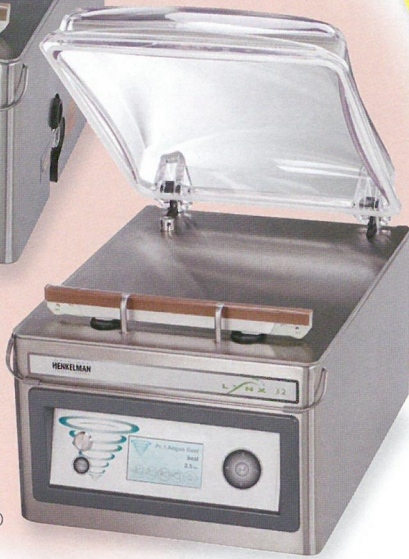
LYNX 32 ○390×529×382 ○シール有効寸法:320×1本 ○100V 1000W(50/60Hz)
