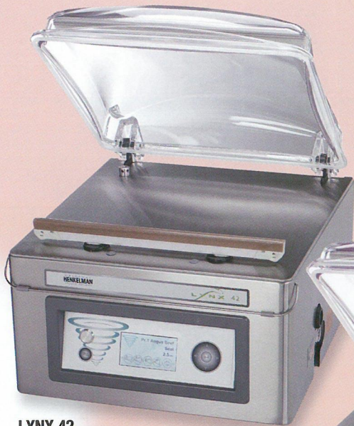
LYNX 42 ○491×529×395 ○シール有効寸法:420×1本 ○3φ200V 1200W(50/60Hz)
