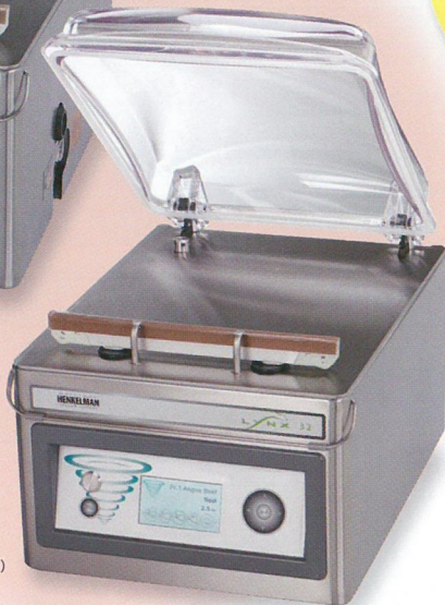
LYNX 32 ○390×529×382 ○シール有効寸法:320×1本 ○100V 1000W(50/60Hz)
