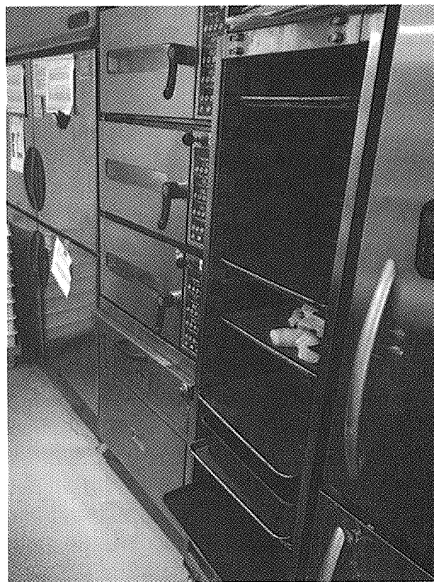
パンシェルフはオーブンとホイロの間に設置するのが理想
