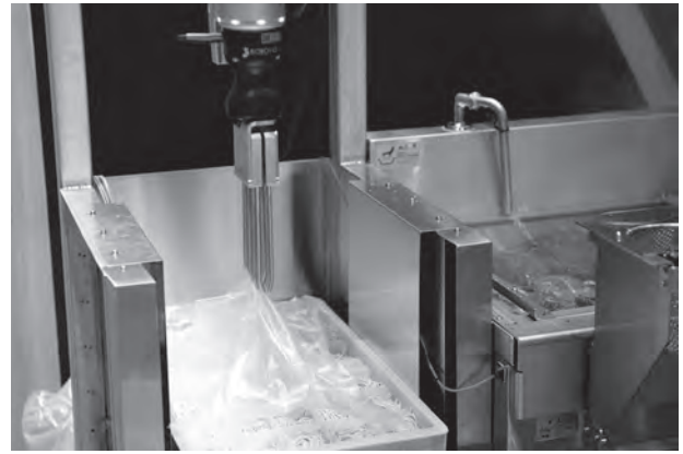
乾燥防止のフィルムを取り除く所から作業スタート
