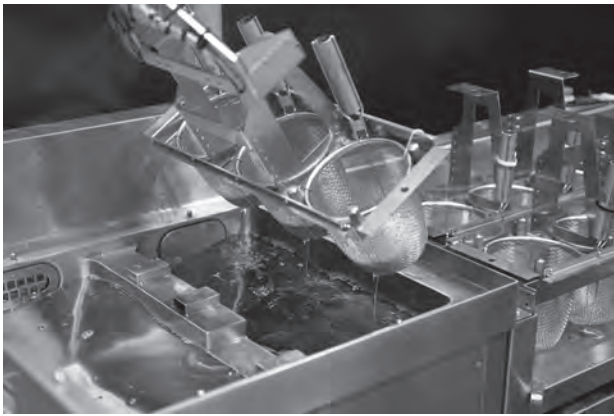
人間と同じように、ゆでざるを傾けて水を切るロボット
