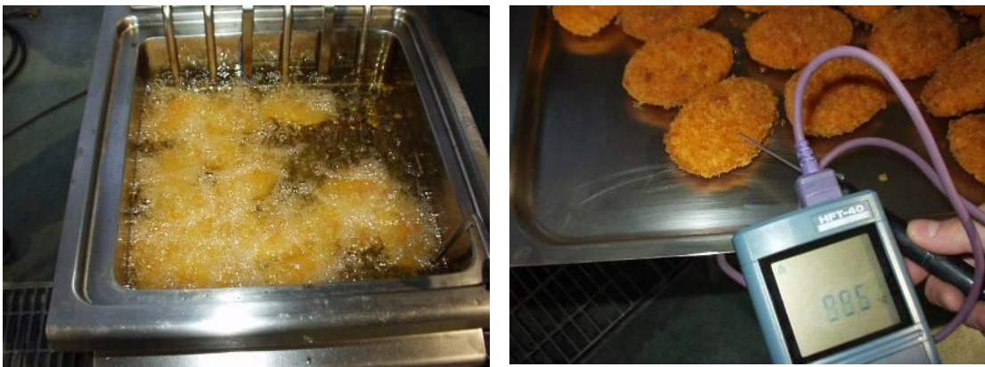
図 8.9.7, 図 8.9.8 調理能力試験[①冷凍コロッケ]
