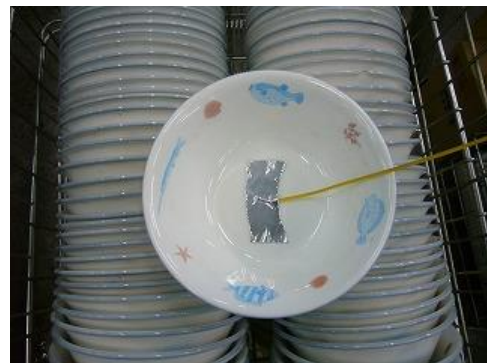
図 8.13.2 温度センサーの貼り付け
