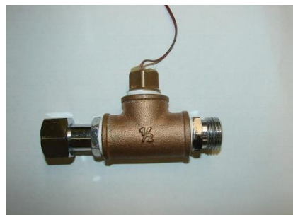
図 8.11.1 熱電対を取り付けた継ぎ手配管
