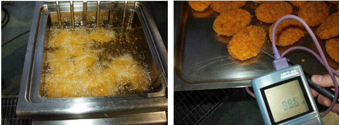
図 7.9.6 、図 7.9.7 調理能力試験 [①冷凍コロッケ]
