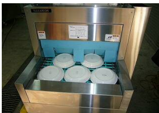
図 7.12.2 フラットコンベア型のコンベア上の食器
