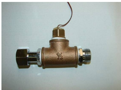
図 7.12.1 熱電対を取り付けた継手配管
